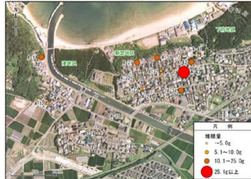
飛砂堆砂量分布（出典：「新宮海岸飛砂対策調査業務委託報告書」平成24年3月、新宮町都市整備課・一般財団法人九州環境管理協会）
